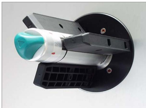
[71] Posición del adaptador nuclear para diámetro de núcleo de 101,6 mm.
